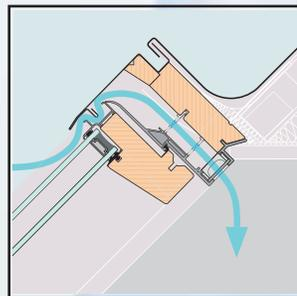
Únicas en Chile con sistema de ventilación en el marco, no en la hoja, lo que permite un 6% más de superficie acristalada garantizando un caudal de luz superior
